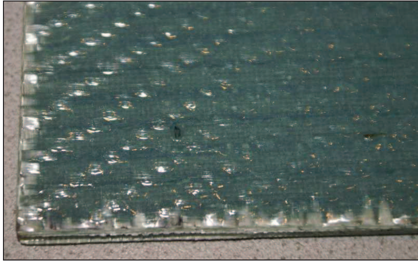
Fot. 2. Przykład ścianki z laminatu z przestrzenią do monitorowania wycieków Photo. 2. Example of the laminate wall with the space for monitoring leaks
