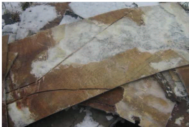
Fot. 7. Powłoka z laminatu przeznaczona do utylizacji
