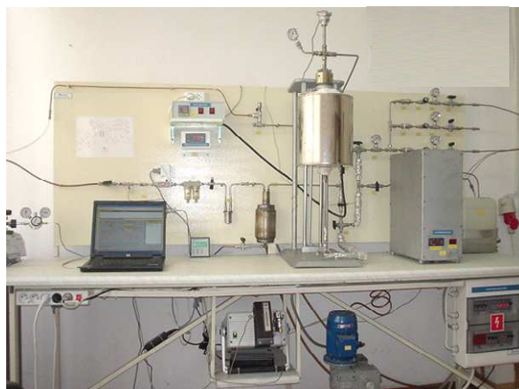
Fot. 1. Instalacja do badania procesów katalitycznego zgazowania węgla w reaktorze ze złożem stałym (Smoliński 2007, 2010)
